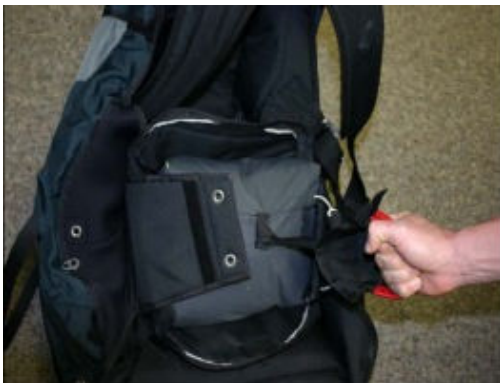
Empfehlenswert: Nach dem Öffnen der Splinte ist der Innencontainer frei und kann sofort weggeschleudert werden.
