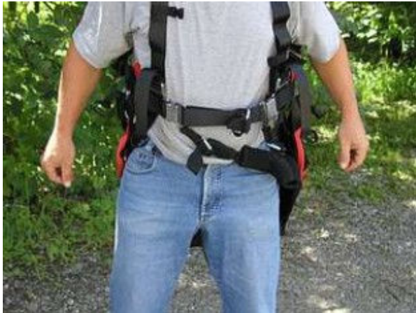
Gurtzeug mit "Get Up-System". Fehlerhaft geführte Beingurte. Beide Gurte werden seitlich an einem Oberschenkel vorbei geführt und mit dem Brustgurt verbunden. Keine Sicherung, Herausfallen leicht möglich.
