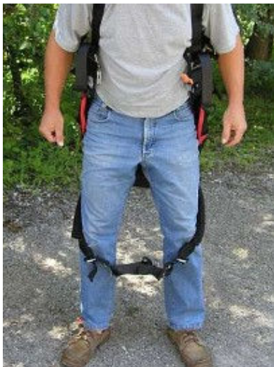
Fehlerhaft geführte Beingurte. Die Beingurte laufen beidseitig neben den Beinen. Der Pilot ist in den Zwischen- raum, zwischen linkem und rechtem Beingurt "eingestiegen". Keine Sicherung, Herausfallen leicht möglich.
