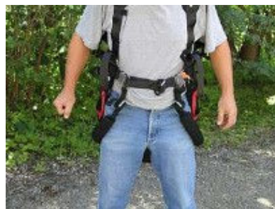
Fehlerhaft geführte Beingurte. Die Beingurte laufen beidseitig neben den Beinen. Der Pilot ist in den Zwischen- raum, zwischen linkem und rechtem Beingurt "eingestiegen". Keine Sicherung, Herausfallen leicht möglich.
