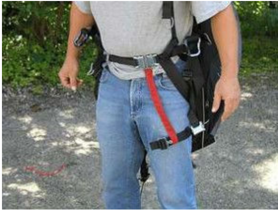
Konventionelles Gurtzeug mit separat verschließbaren Beingurten und Herausfallsicherung. Offene Beingurte und fehlerhaft geführte Herausfallsicherung. Herausfallen leicht möglich.
