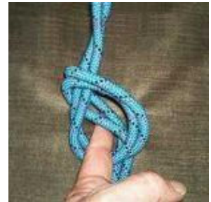
Das fortlaufende Ende durch das Auge ziehen.
