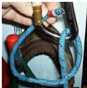
Das freie Seilende wird vor dem fortlaufenden Ende herum und von hinten durch den Karabiner geführt.
